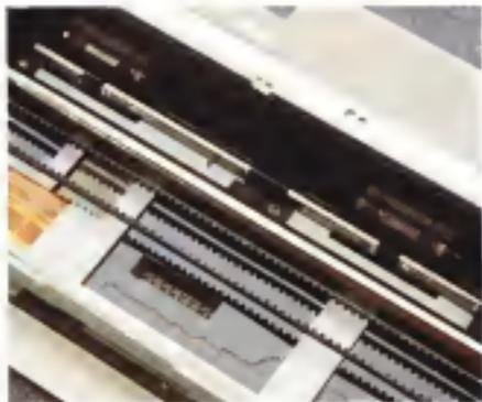
Due parti del sistema elettronico: i piccoli dip-switch per il controllo di alcune funzioni e la cartuccia di nastro da inserire nell'apposito ricettacolo.
